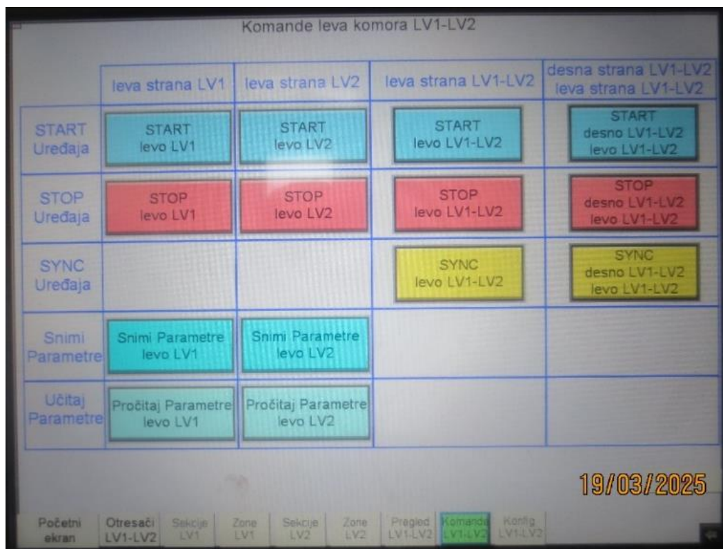
Слика 10: Екран са опцијама старт/стоп режима и синхронизације отресања
