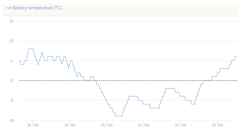
Slika 4: Radna temperatura baterijskog skladišta
