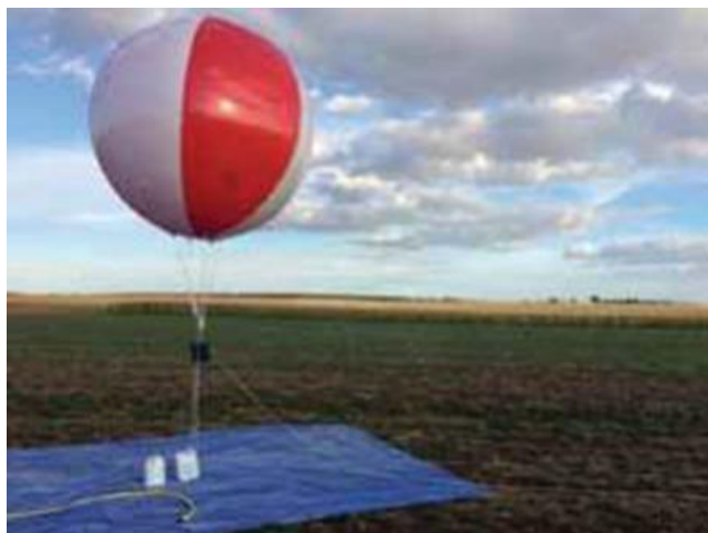
Слика 2.9: Хелијумски балон са аутоматским детектором за испитивање активности на реалним висинама
