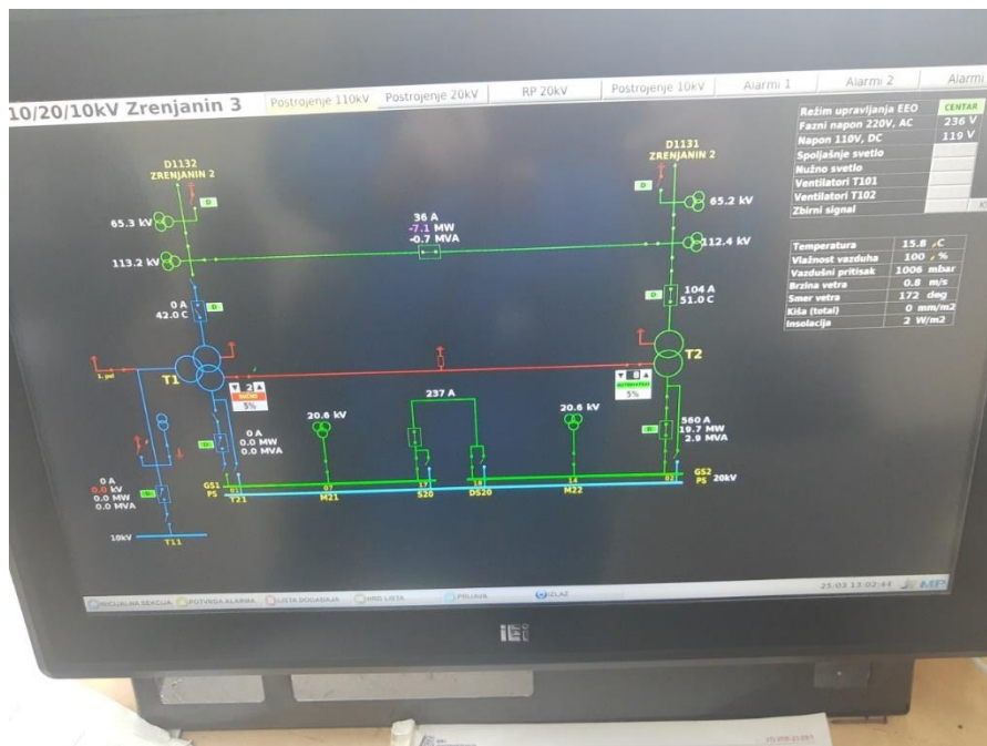
Slika 2: Razlika napona zbog neažuriranja podataka o primarnom međufaznom naponu
