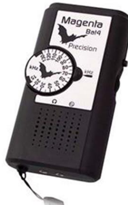
Слика 2.7: Ручни детектор слепих мишева
