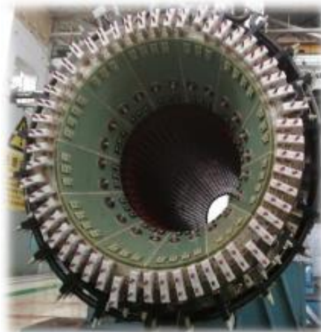
Slika 2.2: Savremena tehnologija krutog učvršćenja zalivanjem u epoksidnu smolu
