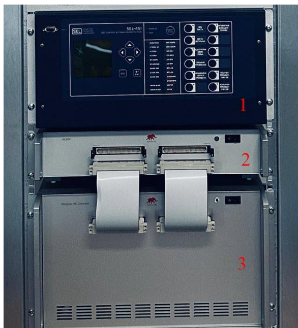
Slika 5: Laboratorijska postavka ispitivanja: 1 - SEL-451 zaštitni uređaj, 2 – Typhoon HIL 604, 3 - HIL Connect)
