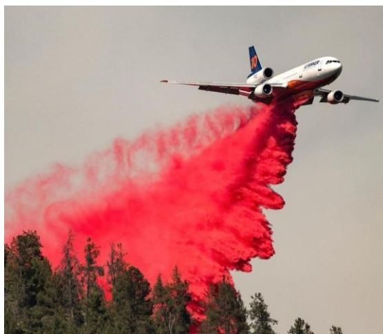
Slika 3. Usporivači požara aplikovani iz aviona
