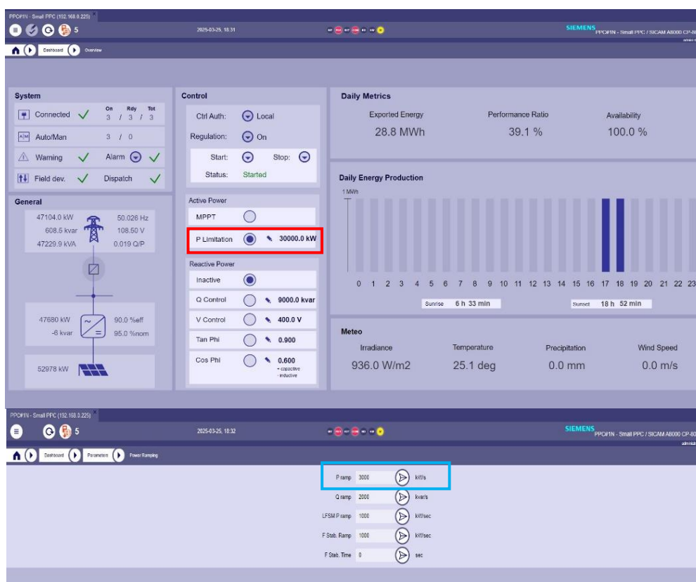
Slika 8: Prva postavna vrednost za aktivnu snagu (crveno) i postavljeni gradijent (plavo) u kontroleru
