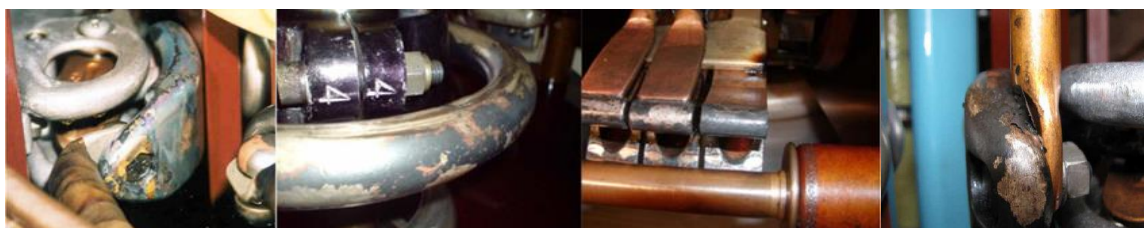
Slika 1: Korozija na srebru unutar suda TRP [16].
