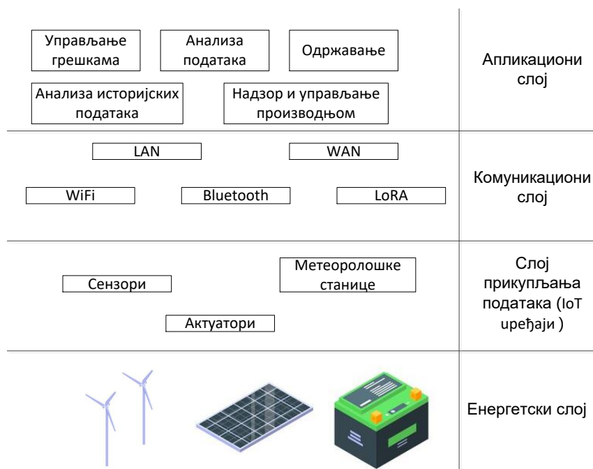
Слика 1. IoT-базирана комуникациона архитектура система ОИЕ [3], [4]
